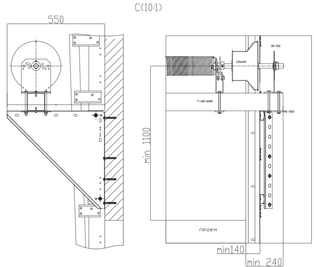
Дополнительные параметры проема при использовании цепного редуктора СН0501.
