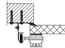
б) монтаж к стене, УГОЛОК ВНУТРИ СТОЙКИ
